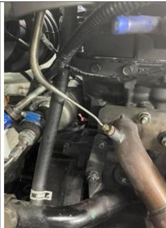
Figure 1.3 – Thermocouples à tige
