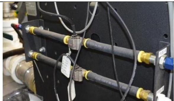
Figure 1.4 – Capteur de consommation de carburant
