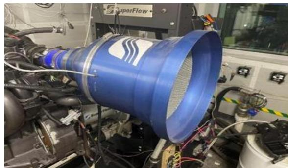
Figure 1.5 – Débitmètre d'air
